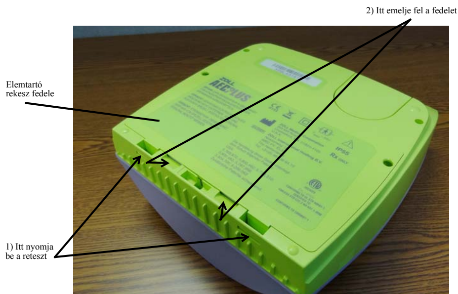
6. ábra: Az elemtartó rekesz fedelének eltávolítása
